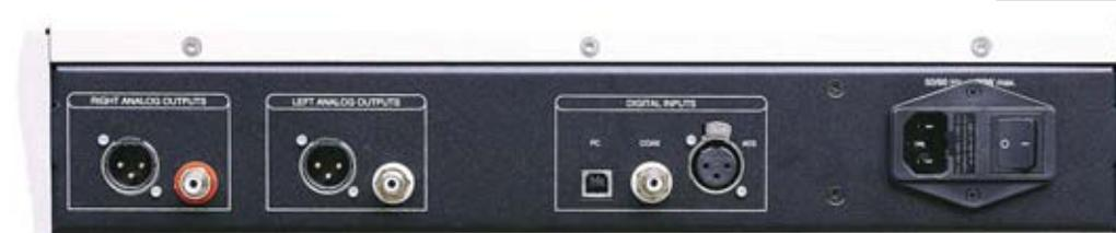
*Molto pulito ed essenziale il retro dell'apparecchio: c'è la triade degli ingressi digitali (ci sono "solo" gli elettrici, manca l'ottico) e ci sono le uscite analogiche RCA e bilanciate.*
