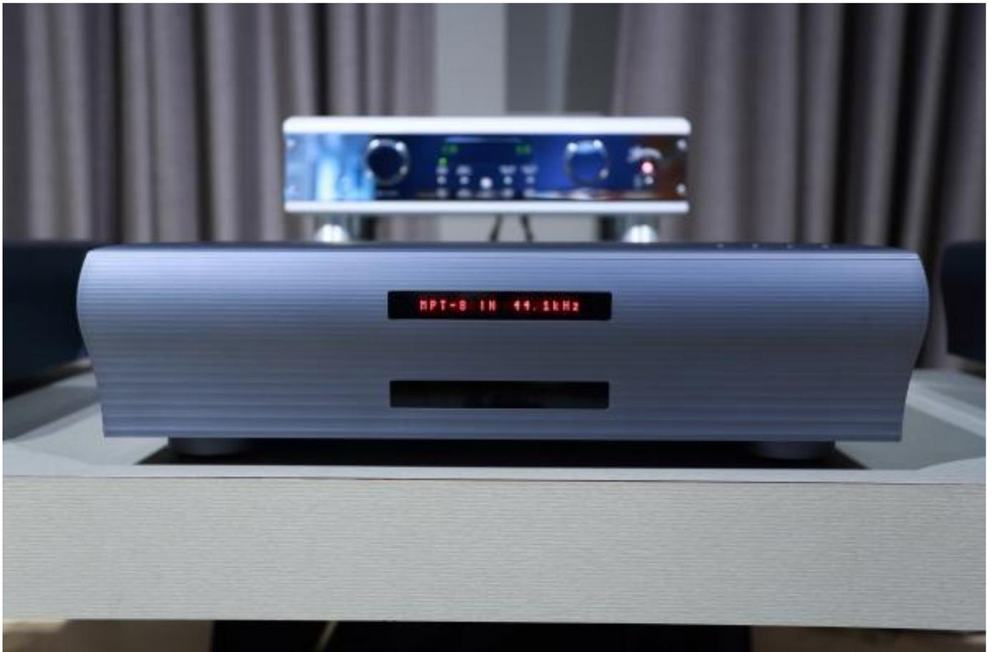
MPD-8 的音控使用階梯式電阻，以切換開關來控制訊號要通過的電阻，共分 256 階，可進行極精細的調控。特別的是，MPD-8 以數位方式控制切換開關的作動，因此可兼顧精準控制，以及類比電阻音控不減損訊號量的優點。在不同音量時，MPD-8 的訊噪比都非常優異，且訊噪比不會因音量而變化。
