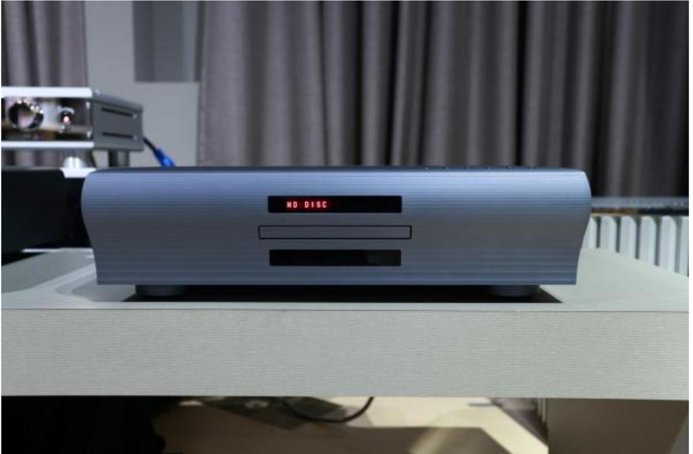
最後 Andreas Koch 表示，MPT-8 與 MPD-8 的兩件式設計，是 Playback Design 現階段最高的技術了，他們已想盡辦法把任何部分做到最好，足可與市面上任何高階訊源一較高下。如果嫌分體機忙凡，希望較簡單的配置，則可選擇 MPS-8 唱盤，它具備和 MPT-8 與 MPD-8 相同的功能，也可選配 Stream-X，可支援所有的數位播出方式。MPS-8 內部也盡可能做到隔離，內含 2 顆電源變壓器，分別供應數位與類比電路。雖然因內部空間有限，MPS-8 電路採差動放大，而非雙差動，但也已經比過往經典機 MPS-5 明顯更好。想要體驗 Playback Design 新一代的最高技藝嗎？趕緊預約試聽吧！
